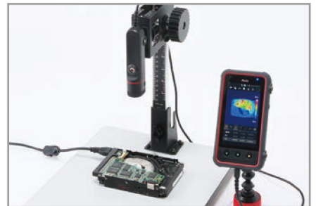
攝影鏡頭和主機雙配備標準三角架螺絲孔，可以穩固地安裝在三角架上。
