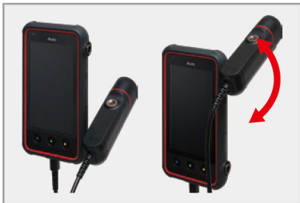
鏡頭旋轉：可將攝影鏡頭裝在控制主機側邊卡榫，任意旋轉鏡頭方向。
